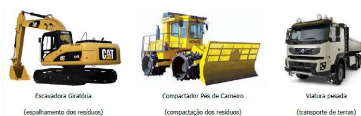
Figura 3.6 – Máquinas e veículos utilizados na frente de Aterro.
