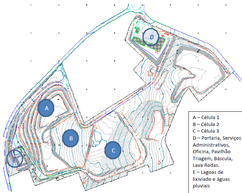
Figura 3.1 – Layout da instalação.
